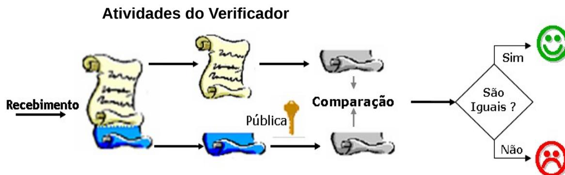
Figura 5.2 – Diagrama simplificado de verificação de assinatura
